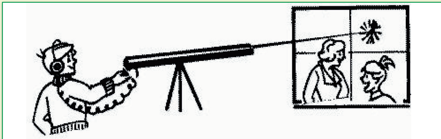
▲ Ecco come funziona un microfono laser autocostruito per l'intercettazione di una conversazione dietro un vetro.
